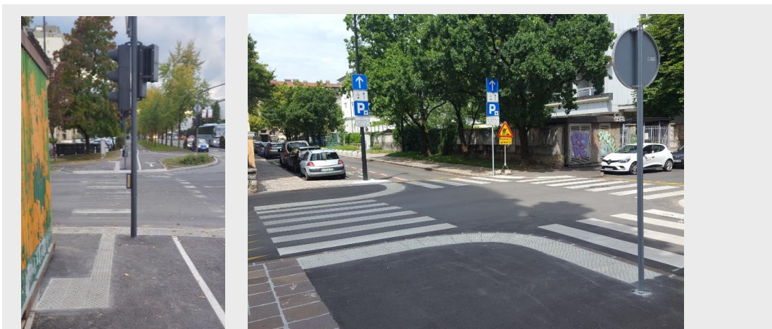
Slika 67 (ustrezno): Bistvena razlika med TTVS v višji stopnji dostopnosti in osnovni stopnji dostopnosti je vidna pri opremljanju križišč. 1: Primer opremljenosti križišča na poti višje stopnje dostopnosti. Taktilne oznake so povezane z vodilnimi robovi. 2: Na križišču v območju osnovne dostopnosti taktilne oznake zagotavljajo samo osnovno varnost pešcem z okvarami vida (čepaste oznake na robu vozišča opozarjajo na višinsko izenačen rob ceste, ki ga sicer ljudje z okvaro vida ne morejo zaznati).
