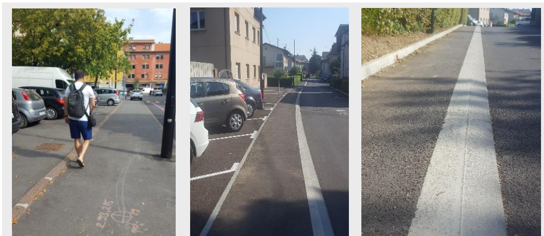
Slike 30 (ustrezno): Ustrezna rešitev v primeru, ko je ob pločniku načrtovano parkirišče. 1: meja med parkiriščem in pločnikom je nakazana kot robnik, visok 3 cm, ki mu slepi lahko sledijo s palico. 2 in 3: Primer ležečega robnika v primeru manj prometnih cest, ob katerih je veliko uvozov in parkirišč ob pločniku. Meja med voziščem in pločnikom je poševni robnik, ki je tipno zaznaven, obenem pa omogoča avtomobilom, da zapeljejo na dovoz.
