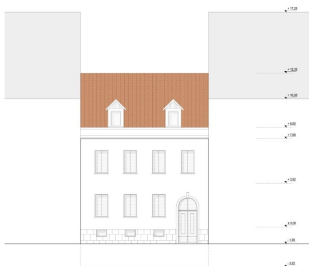
Slika 10: Obstoječa severna fasada; Vir: RAP-ING d.o.o.
