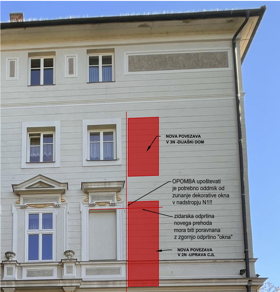
Predvidena je rušitev zunanjih sten na obstoječem objektu Janeza Levca zaradi novih povezav do predvidene prizidave. Rušenja dela opečne fasadne stene, deb. 40,0 cm na mestu izvedbe prehoda med novim in obstoječim objektom, rušenje se izvede s predhodnim zarezovanjem linije rušenja.
